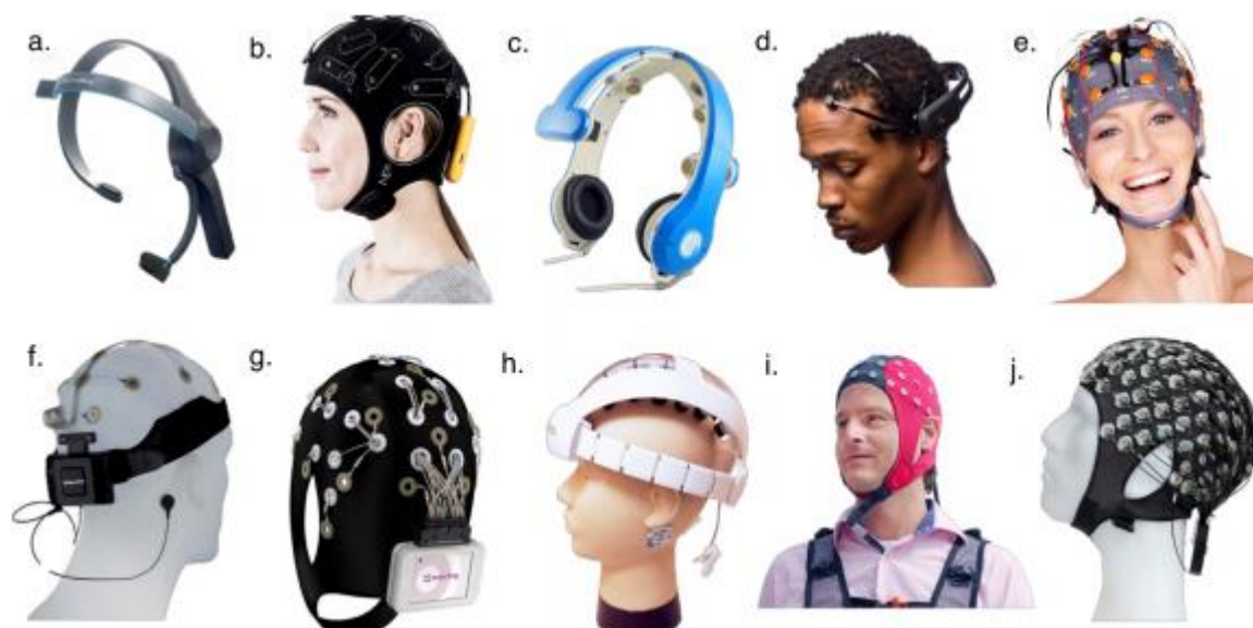
ภาพประกอบ 2 ตัวอย่างอุปกรณ์สวมใส่สำหรับเก็บสัญญาณสมอง (a) MindWave (b) ENOBIO 8 (c) BR8+ (d) EPOC (e) g.SAHARA (f) B-Alert X24 (g) Smarting (h) Trilobite (i) eego sport (j) Mobile-128 (Lau-Zhu; Lau; & McLoughlin. 2019)
