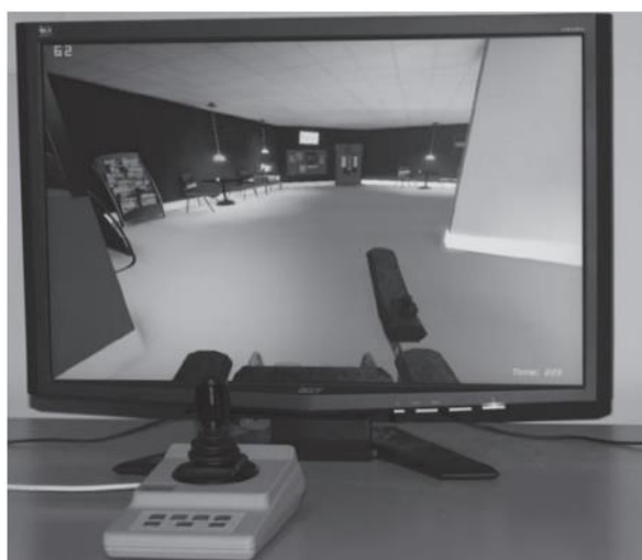
ภาพประกอบ 6 การจำลองการเคลื่อนที่ของรถเข็นไฟฟ้าด้วยแท่งควบคุม (Archambault; Tremblay; Cachecho; Routhier; & Boissy. 2011)
