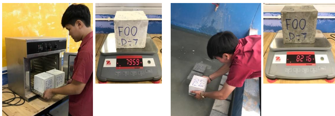
ภาพประกอบ 6 การทดสอบหาค่าการดูดซึมน้ำของตัวอย่างคอนกรีตมวลเบาผสมใยกล้วย
