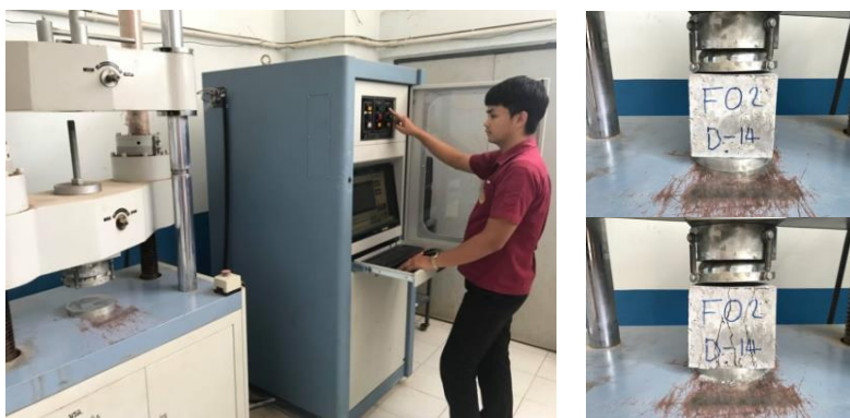
ภาพประกอบ 4 การทดสอบหาค่ากำลังอัดของคอนกรีตมวลเบาผสมใยกล้วย
