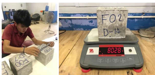
ภาพประกอบ 5 การทดสอบหาค่าหน่วยน้ำหนักของคอนกรีตมวลเบาผสมใยกล้วย
