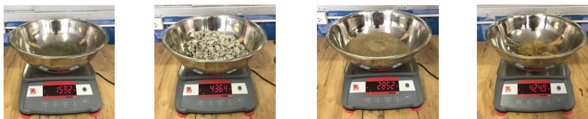
ภาพประกอบ 2 การเตรียมวัสดุผสมรวมผสมคอนกรีตมวลเบาผสมใยกล้วย
