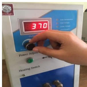
ภาพประกอบ 4 การปรับค่ากระแสไฟฟ้าในการบัดกรีแข็ง
