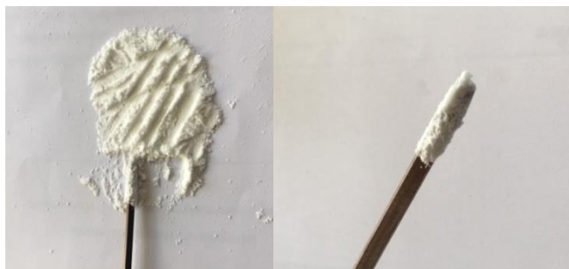
ภาพประกอบ 6 จำนวนของฟลักซ์ที่เป็นความยาวของลวดที่จุ่ม
