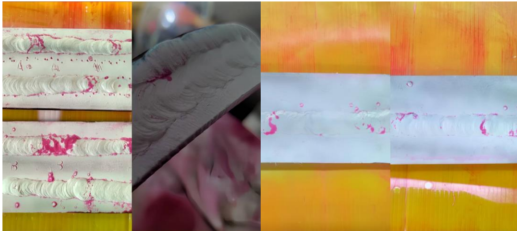
ภาพประกอบ 3 การจำลองข้อบกพร่องของงานเชื่อมไฟฟ้าด้วยลวดเชื่อมหุ้มฟลักซ์
